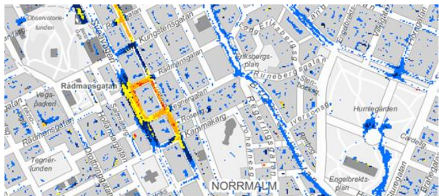
Resultat från Stockholms skyfallsmodell, maximalt vattendjup vid 100-årsregn
